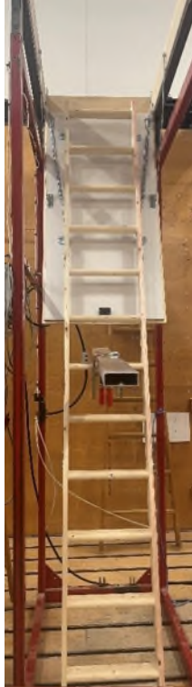
Figure 3: Torsion test setup / Torsionsversuchsaufbau
